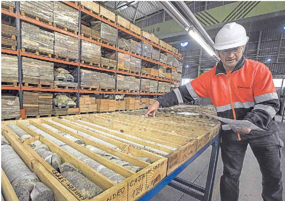
▲ **Geología.** Muestras de las perforaciones realizadas para planificar la excavación de túneles y cámaras.
